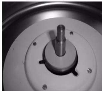
Eje del motor y cámara
